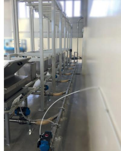
con controllo di peso da svariate stazioni porta Big Bag mediante trasporto pneumatico; vagliatura in linea di sicurezza dei cereali, preparazione, dosaggio e trasferimento salamoia, miscelazione verticale ad aspo e assorbimento liquido da parte dei cereali, successivo svuotamento senza residui, stoccaggio e trasporto mediante batteria di coclee flessibili alle macchine automatiche di processo.
