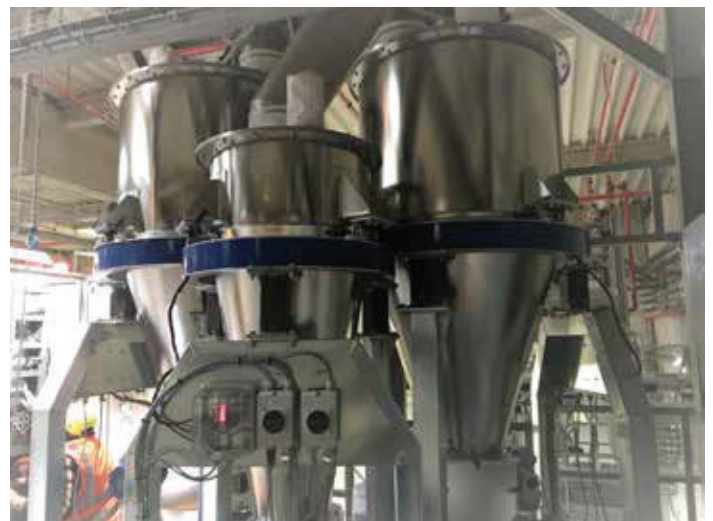
| Solution pour le dosage de flocons PET.
