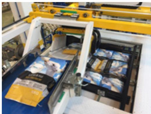
ILERPAL W apporte la meilleure qualité d'empilage grâce au chevauchement des sacs entre eux, en combinaison avec la plateforme mobile et le conditionnement des 5 faces de la palette, c'est-à-dire le compactage des 4 côtés et le repassage de chaque couche.
