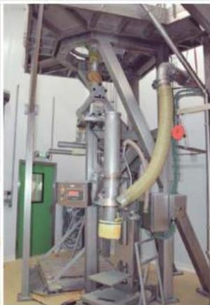
➤ **Conditionnement.** Le système délivre deux sacs de 25 kg par min ou 3 t en big-bags par heure. Entre les tuyauteries, des manchettes BFM Fitting évitent le recours aux boulons.
