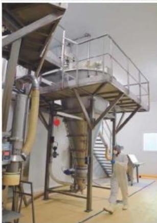
➤ **Mélange.** Le mélangeur Hosokawa Micron 2 t passe actuellement 6 t/h. En sortie, la vanne à segment sphérique ISEM se caractérise par un passage intégral et un logement sans rétention.
