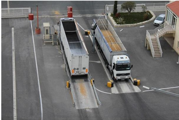
**Pour le pesage routier et ferroviaire :** une large gamme de ponts-bascules associée à des terminaux assurant la gestion du trafic et des entrées-sorties matière et le contrôle du chargement. Le logiciel TRUCKFLOW assure une traçabilité complète de l'ensemble des opérations.
